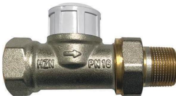
Терmostатический радиаторный клапан с повышенной пропускной способностью для однотрубных гравитационных систем отопления или систем с высоким значением расхода. Возможно исполнение в прямом и угловом вариантах. Подходит для всех терmostатических элементов Heizen, кроме элементов 3-й серии с клипсовым соединением. Не имеет предварительной настройки.
