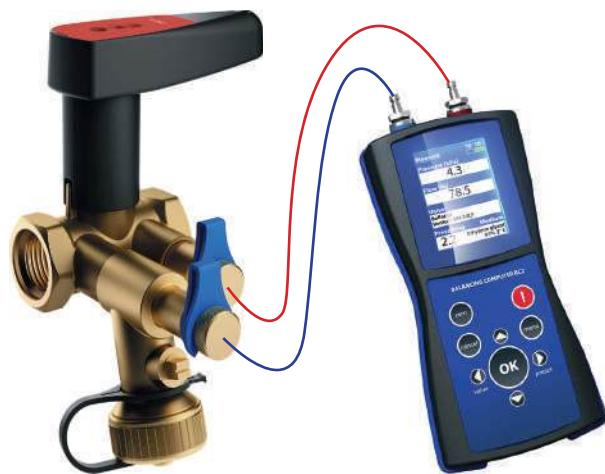
4а. Если в базе данных измерительного компьютера нет данного клапана (в случае применения измерительного компьютера другого производителя), то указываем Kv компонента, который указан у Heizen Stream на рукоятке.
