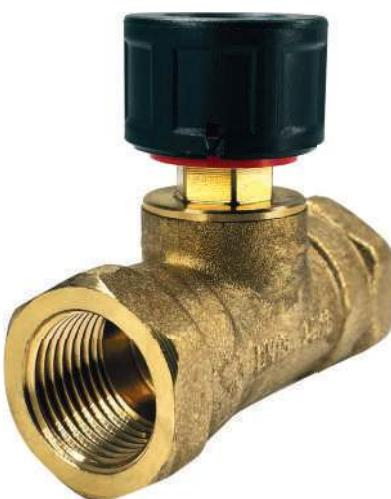
Ручной балансировочный клапан с предварительной настройкой Heizen STB предназначен для гидравлической балансировки в системах отопления. Рекомендуется для установки на отводах по-этажного коллектора.
