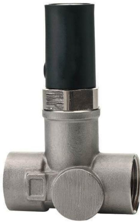
Циркуляционный вентиль HEIZEN VALMIX из нержавеющей стали AISI 316 предназначен для установки на циркуляционных трубопроводах систем водоснабжения и позволяет осуществить гидравлическую увязку за счет постановки определенной преднастройки. Применение циркуляционного клапана обеспечивает температурный баланс в системе горячего водоснабжения путем поддержания постоянной температуры на заданном уровне за счет ограничения расхода в циркуляционном трубопроводе.
