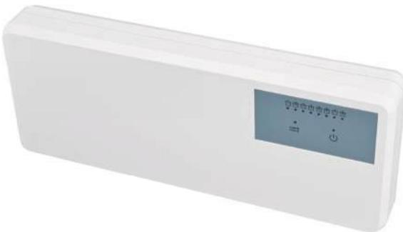
Проводной коммутационный блок (контрольный центр) PT8001 предназначен для управления исполнительными механизмами (котел, циркуляционный насос, подмешивающий клапан, сервоприводы контуров отопления) в зависимости от построенного алгоритма работы. Обеспечивает оптимальное расходование энергии, комфортный климат каждого отдельного помещения, правильную работу всех элементов схемы. Осуществляет одновременный контроль температуры 8 помещений (зон).
