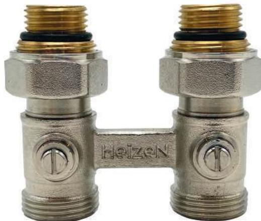
Узел подключения для радиаторов с нижним подключением и межосевым расстоянием 50 мм. Могут применяться в двухтрубных горизонтальных системах отопления. Клапан с функцией запирания для отключения радиатора, для его замены или технического обслуживания. Не допускается использовать клапан для регулировки потока теплоносителя. Запорный шток должен находится только в открытом либо закрытом положении. Поставляется в двух вариантах: прямом и угловом.
