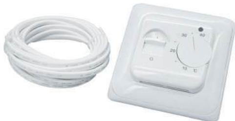
Терморегулятор предназначен для монтажа в стандартную монтажную коробку. Пределы регулирования терморегулятора от +5 °C до +40 °C. Светодиод отображает, когда нагрев включен.
