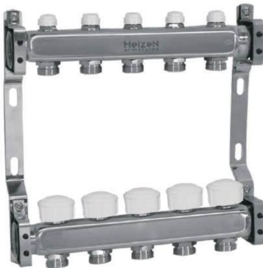
Коллекторная группа из нержавеющей стали AISI 304 Heizen 805. Состоит из подводящего коллектора с запорными вентилями и обратного коллектора с термостатическими клапанами. Поставляется в комплекте с монтажными антивибрационными кронштейнами. Межосевое расстояние 50мм. Применяется для систем высокотемпературного радиаторного отопления, холодного и горячего водоснабжения.
