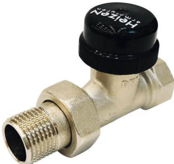
Термостатический радиаторный клапан с предварительной настройкой для двухтрубных систем отопления или систем со средним значением расхода. Возможно исполнение в прямом и угловом вариантах. Подходит для всех термостатических элементов Heizen, кроме элементов 3-й серии с клипсовым соединением.
