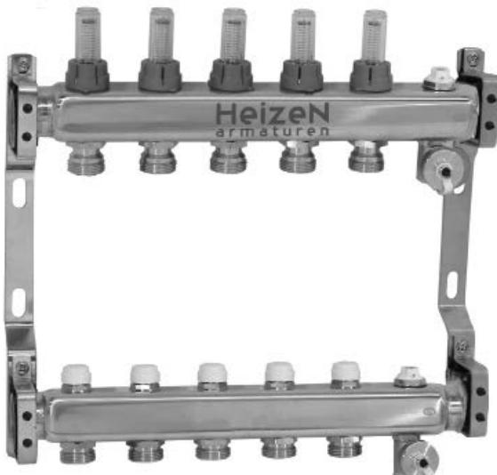
Коллекторная группа из нержавеющей стали AISI 304 Heizen 802. Состоит из подающего коллектора с расходомерами и обратного коллектора с терmostатическими клапанами. Поставляется в комплекте с монтажными антивибрационными кронштейнами. Применяется для систем напольного отопления, холодного и горячего водоснабжения.
