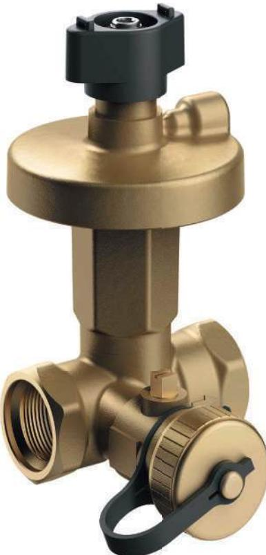
Автоматические балансировочные клапаны-регуляторы перепада давления HEIZEN Auto обеспечивают гидравлическую балансировку путем поддержания перепада давления на постоянном уровне, вне зависимости от меняющихся характеристик расхода в системе.
