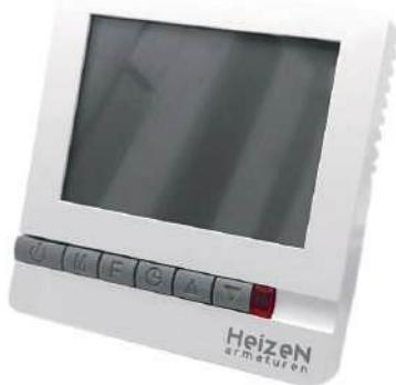
Электронные комнатные термостаты Heizen 825DC предназначены для автоматического (ВКЛ/ВЫКЛ) управления газовыми котлами, циркуляционными насосами и зональными клапанами в системах отопления, охлаждения или отопления/охлаждения, в которых требуется однополюсное или двухполюсное переключение до 10 А (резистивная нагрузка) или 3 А (индуктивная нагрузка).
