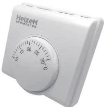
Электромеханические комнатные термостаты 825C предназначены для автоматического (ВКЛ/ВЫКЛ) управления газовыми котлами, циркуляционными насосами и зональными клапанами в системах отопления, охлаждения или отопления/охлаждения, в которых требуется однополюсное или двухполюсное переключение до 10 А (резистивная нагрузка) или 3 А (индуктивная нагрузка).
