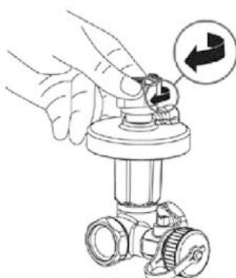
Перекрытие потока осуществляется поворотом черной ручки по часовой стрелке до упора. Чтобы избежать повреждения мембранны, потеря давления на клапане после отключения не должна превышать 250 кПа. В качестве альтернативы можно демонтировать капиллярную трубку с одной стороны перед перекрытием потока для защиты Heizen Auto. Когда клапаны перекрыты, можно слить теплоноситель с регулируемого участка с помощью дренажного крана 3/4" Heizen Auto.
