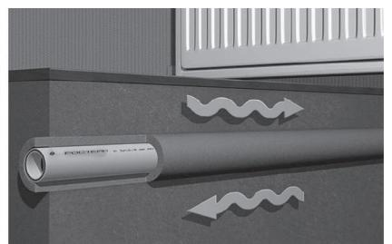
В случае скрытой прокладки трубопровода канал, в который укладываются трубы, должен быть свободным и обеспечивать компенсацию линейного расширения. Стояки должны быть изолированы или защищены гофрированной трубой, оптимально использование пенополиуретановой изоляции и механической защиты трубопровода.
