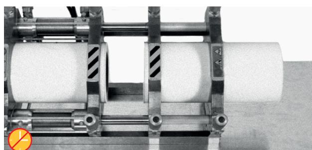
5. Незамедлительно после того, как нагревательный элемент убрали в сторону, трубы вновь сдвигаются установленными на сварочном аппарате салазками.
