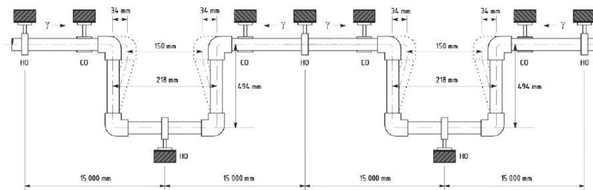
Полученные данные определяют размеры П-образного компенсатора, равные: 494 х 218 мм.
