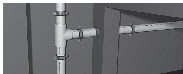
**При скрытой прокладке**, обеспечив расположение хомута жесткого крепления перед каждым ответвлением трубы, разрешается пренебрегать линейным расширением в случае использования армированных стекловолокном труб, т. е. устанавливать стояки без компенсационных колен. В таком случае образующееся линейное расширение между жесткими опорами не оказывает отрицательного воздействия. При этом необходимо следить за тем, чтобы расстояние между неподвижными опорами на стояках не превышало 3 метров.
