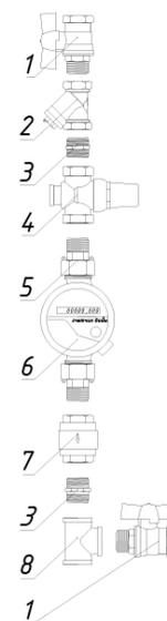
**Водомерный узел РОСТерм Ду15 со счетчиком в комплекте**
