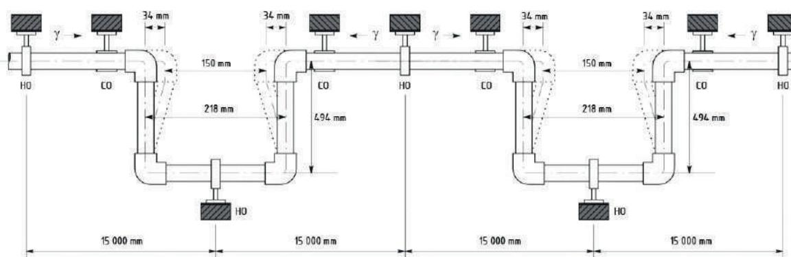
Полученные данные определяют размеры П-образного компенсатора, равные: 494 x 218 мм.
