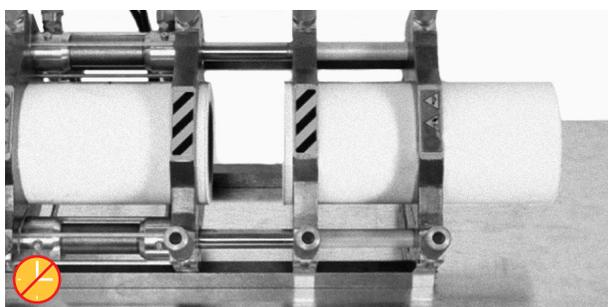
5. Незамедлительно после того, как нагревательный элемент убрали в сторону, трубы вновь сдвигаются установленными на сварочном аппарате салазками.
