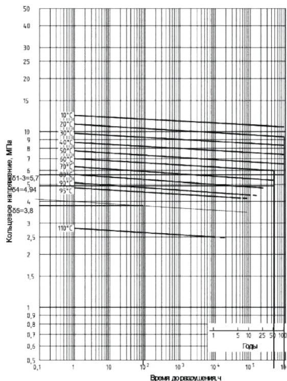
Определяем расчетное напряжение в стенке трубы с учетом действия коэффициентов запаса прочности:
