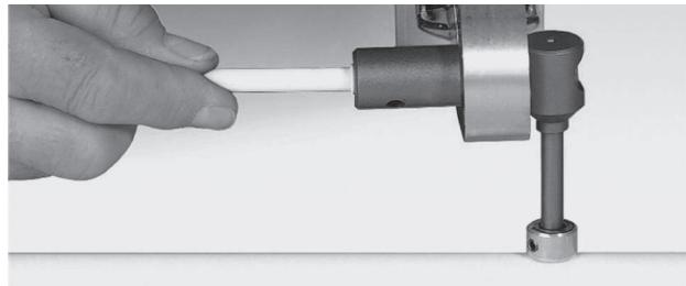
Единовременно необходимо начать разогрев внутренних стенок поврежденной трубы и ремонтного цилиндра, выдержав время нагрева — 5 секунд. Затем разогретый ремонтный цилиндр нужно вставить в нагретое отверстие, избегая осевого вращения цилиндра.
