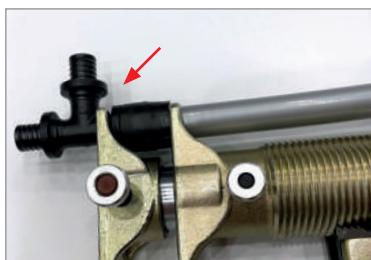
7. Проведите запрессовку до тех пор, пока гильза не соединится с колцом фитинга полностью, рекомендуется избегать зазоров и несоосности соединения между фитингом и гильзой.
