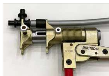
6. Вставьте фитинг в зажимной инструмент.
