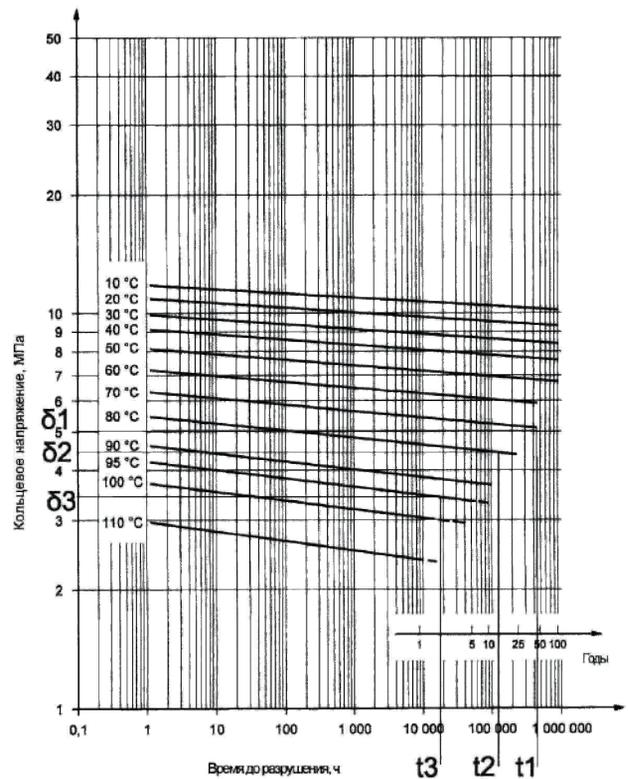
$T_{\text{раб1}} > 900\,000$  ч (102,74 года),  $T_{\text{раб2}} > 450\,000$  ч (51,37 года),
