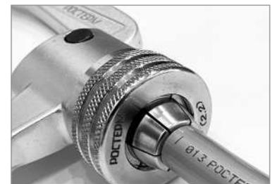
3. Проведите экспандирование трубы РЕ-Х в три этапа (30%, 70%, 100%), между этапами проворачивая расширяемую трубу на 30° вокруг своей оси.
