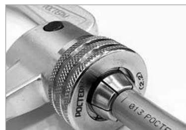
3. Проведите экспандирование трубы РЕ-Х в три этапа (30%, 70%, 100%), между этапами проворачивая экспандируемую трубу на 30° вокруг своей оси.
