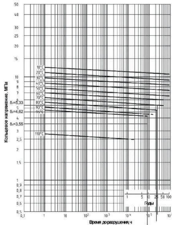
Далее из правила Майнера следует, что если время до разрушения трубы составляет  $t_1$  (лет) при непрерывном действии температуры  $T_1$ , то отношение  $1/t_1$  — это «доля повреждения», приходящаяся на год при непрерывном действии указанной температуры. Если действие этой температуры в течение года непрерывно и составляет величину  $a_1$ , то «доля годового повреждения» составляет  $a_1/t_1$ .
