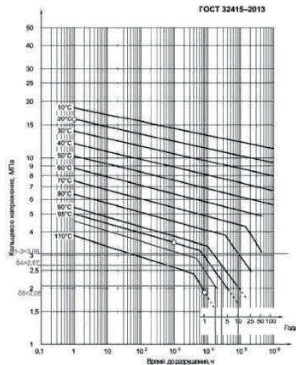
Таким образом, в соответствии с ГОСТ 32415-2013, для класса эксплуатации 5 расчетный срок службы данной трубы **27,48 года**, с рабочим давлением 9,2 бара.
