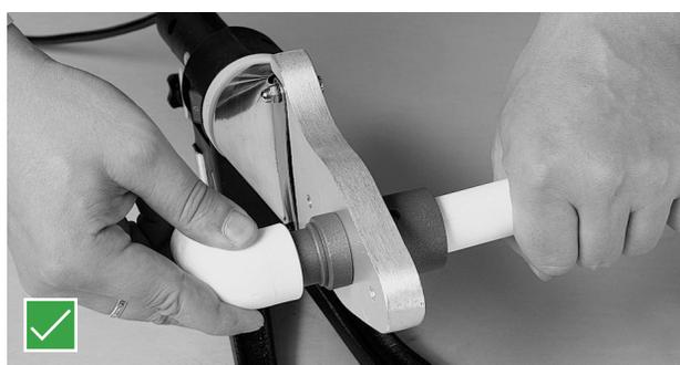
После окончания нагрева нужно снять трубу и фитинг с насадки и медленным поступательным движением произвести соединение элементов. Время с момента снятия с нагревательной плашки до момента соединения нагретых элементов не должно превышать указанного в таблице № 5.
