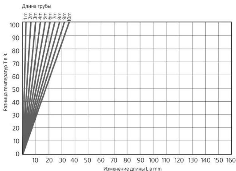
Таблица № 4. Таблица линейного расширения в зависимости от температуры и длины отрезка трубы
