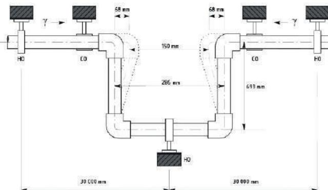
Если архитектура здания не позволяет установить данный компенсатор, то следует увеличивать количество компенсаторов, уменьшая их размеры. Для этого разбиваем прямолинейный участок на два при помощи неподвижной опоры. После чего рассчитываем на каждый из полученных участков П-образный компенсатор, состоящий из 4 Г-образных компенсаторов с компенсационными отрезками 15 м.
