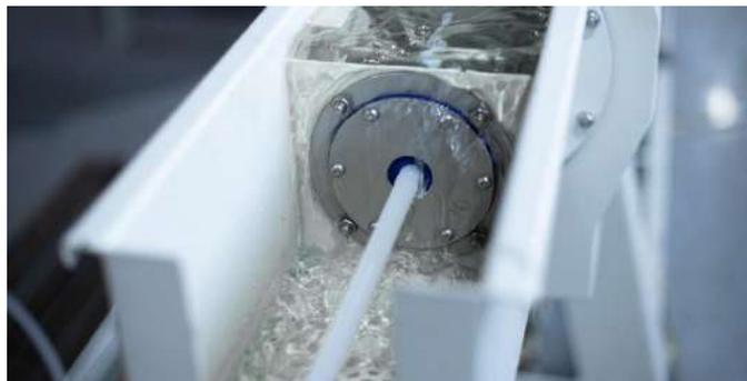
Контроль за производственным процессом, помимо наблюдения со стороны операторов и сотрудников службы качества, происходит посредством ультразвукового измерения. Контрольно-измерительное оборудование обеспечивает контроль и соблюдение заданных размеров уже в процессе изготовления. В случае отклонения от заданных параметров ультразвуковой прибор автоматически передает сигнал, посредством которого продукция отбраковывается с последующей наладкой оборудования.
