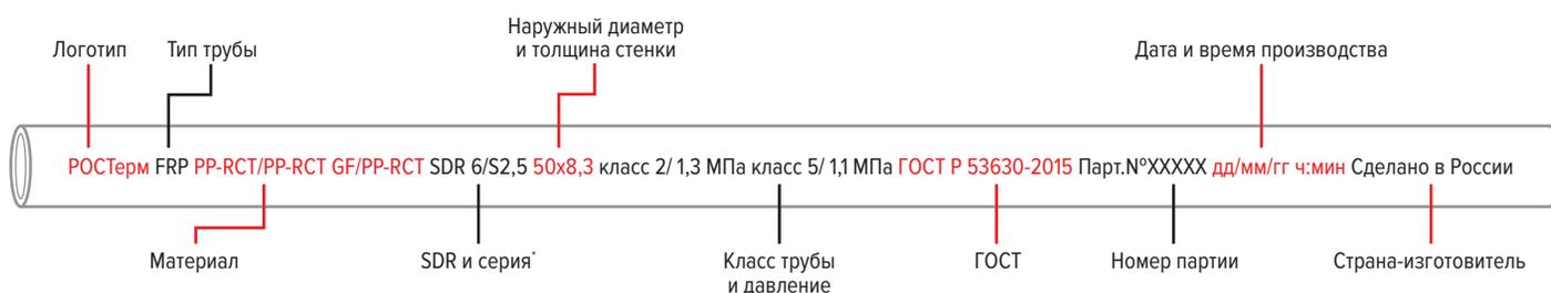
\* Серия труб S (номинальная) — безразмерная величина, определяемая как отношение расчетного напряжения к максимальному допустимому рабочему давлению.
