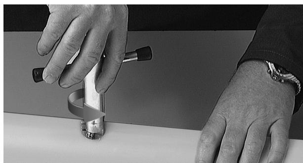
Спустя 30 секунд сварочный аппарат извлекается из тела трубы, а вварное седло извлекается с нагревательной плашкой, после чего незамедлительно вставляется в нагретое отверстие трубы.
