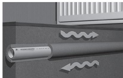
В случае скрытой прокладки трубопровода канал, в который укладываются трубы, должен быть свободным и обеспечивать компенсацию линейного расширения. Стойки должны быть изолированы или защищены гофрированной трубой, оптимально использование пенополиуретановой изоляции и механической защиты трубопровода.
