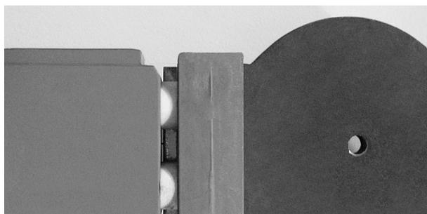
2. Одновременно оба конца трубы подаются к нагревательному элементу под давлением.
