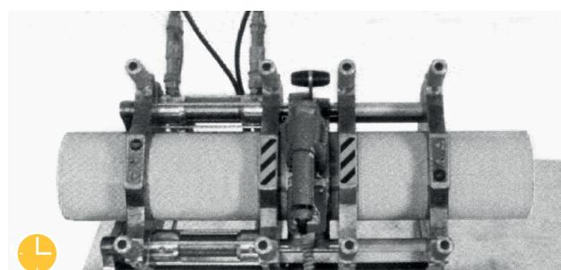
4. После окончания времени нагрева трубы отводятся от нагревательного элемента, и нагревательный элемент убирается в сторону.
