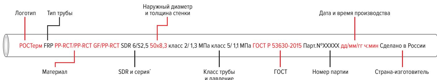
\* Серия труб S (номинальная) — безразмерная величина, определяемая как отношение расчетного напряжения к максимальному допустимому рабочему давлению.
