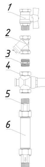
**Водомерный узел РОСТерм Ду15 с отводом под УВП и счетчиком в комплекте**
