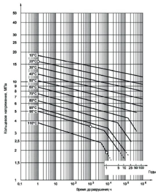
**Таким образом, в соответствии с ГОСТ 32415-2013, для класса эксплуатации 2 срок службы данной трубы 26,11 года с рабочим давлением 7,8 бара.**
