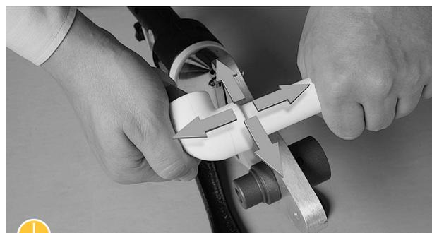
Трубы диаметром 50–125 мм с целью удобства и упрощения монтажа рекомендуется сваривать специальным сварочным аппаратом. Такой сварочный аппарат является стационарным инструментом и за счет встроенного фиксирующего механизма элементов позволяет осуществлять предварительный высокоточный монтаж сложных конструкций или элементов системы.
