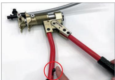
8. Потяните вниз блокиратор, чтобы разъединить рычаг и насадку на тиски, поднимите ручку тисков в верхнее положение, тиски автоматически разъединяются.
