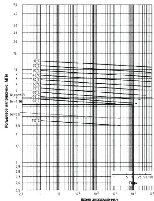
Далее из правила Майнера следует, что если время до разрушения трубы составляет  $t_1$  (лет) при непрерывном действии температуры  $T_1$ , то отношение  $1/t_1$  — это «доля повреждения», приходящаяся на год при непрерывном действии указанной температуры.
