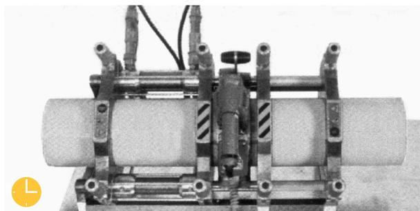
4. После окончания времени нагрева трубы отводятся от нагревательного элемента, и нагревательный элемент убирается в сторону.
