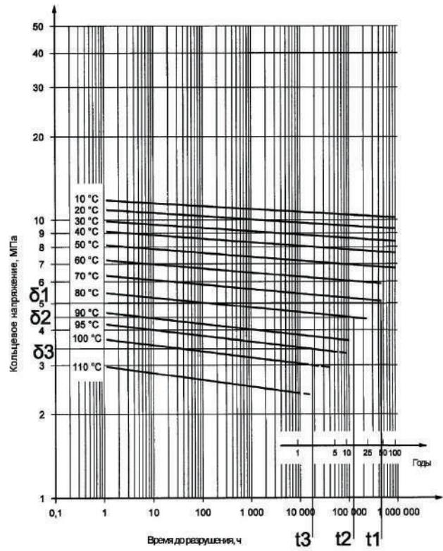
$T_{\text{раб1}} > 900\ 000 \text{ ч}$  (102,74 года),  $T_{\text{раб2}} > 450\ 000 \text{ ч}$  (51,37 года),
