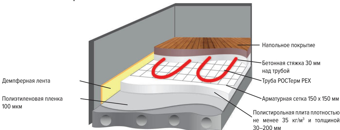
\*Конструкция соответствует СП 29.13330.2011 и чертежам типовых деталей полов 2.144-1/88 (узлы 63, 69, 75, 81, 87), 2.244-1 (узлы 140, 147, 149, 160,161).
