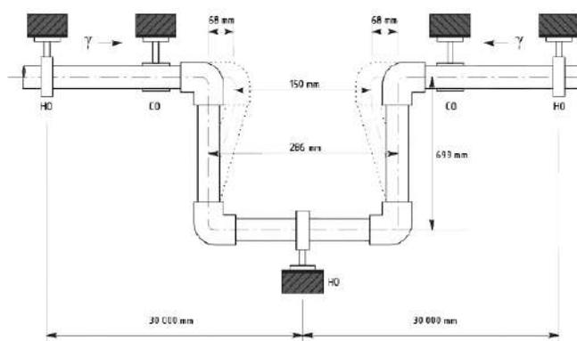
Если архитектура здания не позволяет установить данный компенсатор, то следует увеличивать количество компенсаторов, уменьшая их размеры. Для этого разбиваем прямолинейный участок на два при помощи неподвижной опоры. После чего рассчитываем на каждый из полученных участков П-образный компенсатор, состоящий из 4 Г-образных компенсаторов с компенсационными отрезками 15 м.
