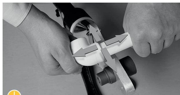
Трубы диаметром 50–125 мм с целью удобства и упрощения монтажа рекомендуется сваривать специальным сварочным аппаратом. Такой сварочный аппарат является стационарным инструментом и за счет встроенного фиксирующего механизма позволяет осуществлять предварительный высокоточный монтаж сложных конструкций или элементов системы.
