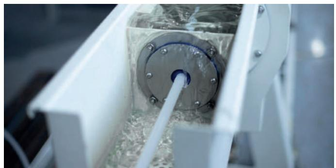
Контроль за производственным процессом, помимо наблюдения со стороны операторов и сотрудников службы качества, происходит посредством ультразвукового измерения. Контрольно-измерительное оборудование обеспечивает контроль и соблюдение заданных размеров уже в процессе изготовления. В случае отклонения от заданных параметров ультразвуковой прибор автоматически передает сигнал, посредством которого продукция отбраковывается с последующей наладкой оборудования.
