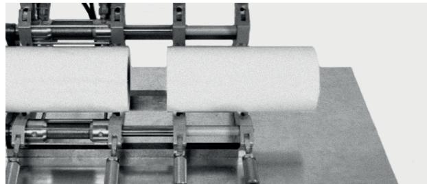
4. Проверить ширину зазора между сведенными трубами (не более 0,5 мм).
