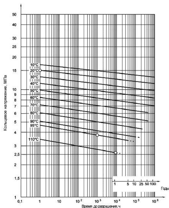
**Таким образом, для класса эксплуатации 2, срок службы данной трубы более 25 лет, с рабочим давлением 13,9 Бар и температурным режимом 70 °C.**
