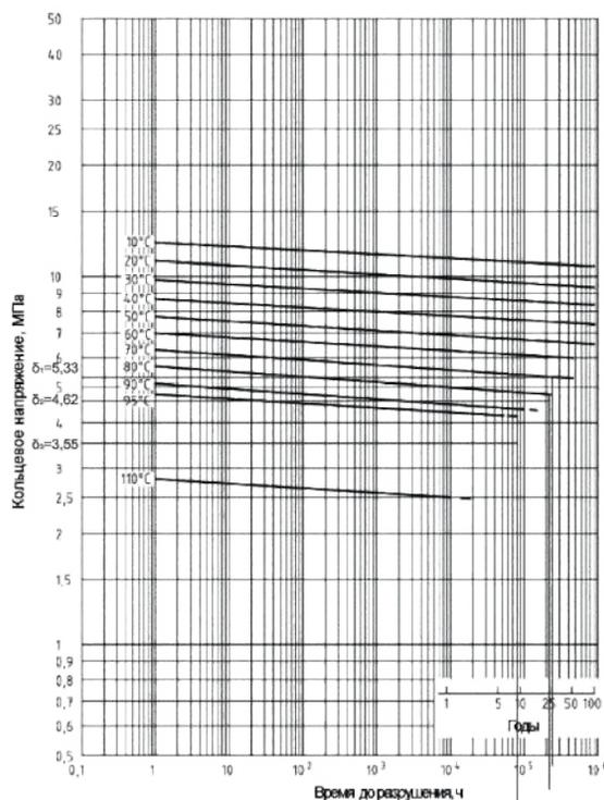
Далее из правила Майнера следует, что если время до разрушения трубы составляет  $t_1$  (лет) при непрерывном действии температуры  $T_1$ , то отношение  $1/t_1$  — это «доля повреждения», приходящаяся на год при непрерывном действии указанной температуры. Если действие этой температуры в течение года непрерывно и составляет величину  $a_1$ , то «доля годового повреждения» составляет  $a_1/t_1$ .
