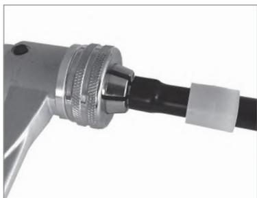
4. Проведите плавное экспандирование трубы PE-X в три этапа (30%, 70%, 100%), между этапами проворачивая расширяемую трубу на 30 градусов вокруг своей оси;
