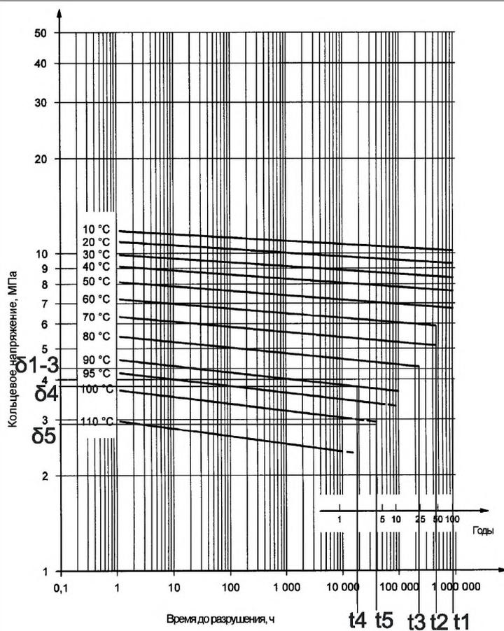
Пользуясь графиком изотермы прочности материала Pert II, определяем время траб,  $t_{\max}$ ,  $t_{\text{авар}}$ , которое труба может выдерживать, не разрушаясь при непрерывном действии каждой из температур в отдельности, при напряжениях в стенке соответственно  $\delta_{1-3}$ ,  $\delta_4$ ,  $\delta_5$ .
