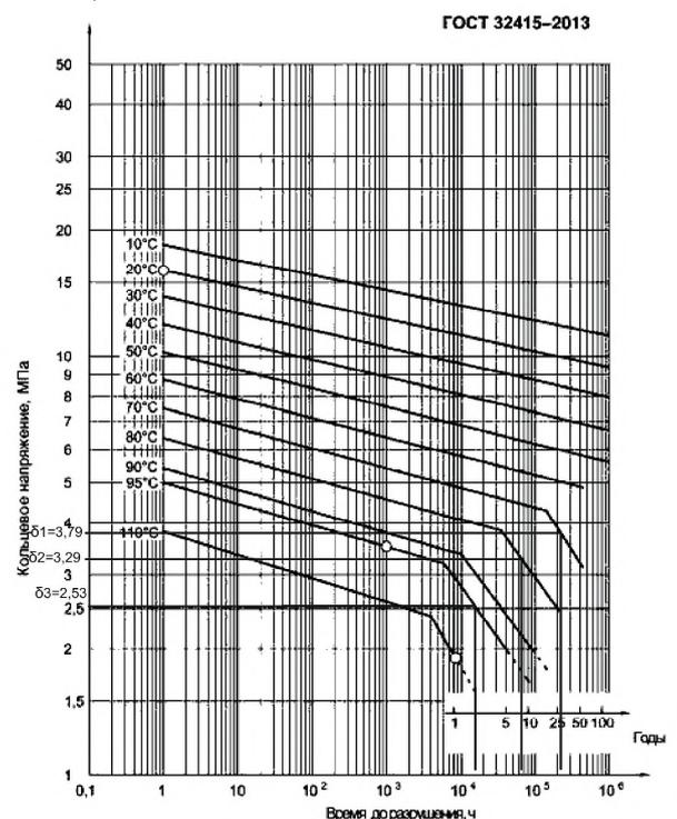
Рисунок В.3 – Эталонные графики длительной прочности PP-R
