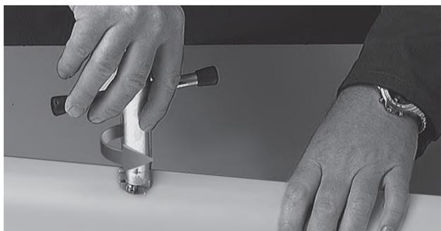
Обезжирив и насухо протерев полученное отверстие, предварительно нагрев и подготовив сварочный аппарат до температуры 260 °С, можно приступить к процессу сварки. Нагревательный штуцер инструмента для вварного седла вставляется в отверстие в стенке трубы до тех пор, пока инструмент полностью не упрется в наружную поверхность стенки трубы. Затем штуцер вварного седла вставляется в нагревательную плашку до тех пор, пока поверхность седла не упрется в край нагревательного элемента.
