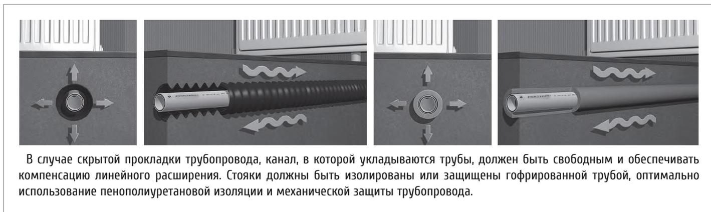
В случае скрытой прокладки трубопровода, канал, в которой укладываются трубы, должен быть свободным и обеспечивать компенсацию линейного расширения. Стойки должны быть изолированы или защищены гофрированной трубой, оптимально использование пенополиуретановой изоляции и механической защиты трубопровода.
