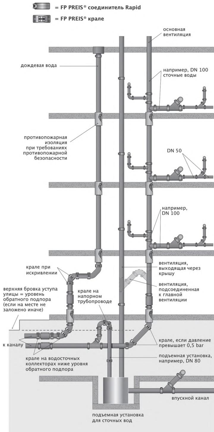
Горизонтальные трубопроводы должны быть достаточно закреплены во всех местах изменения направления и ответвлениях. Спускной трубопровод (стояки) необходимо закреплять с максимальным интервалом в 2 м. В зданиях высотой до 5 этажей стояки от DN 100 необходимо фиксировать от оседания с помощью опоры стояка. Кроме того, в зданиях большей этажности необходимо встраивать на каждом пятом этаже опору стояка.
