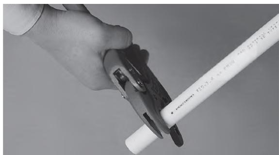
Рекомендуется ножом или специальным инструментом соскоблить внешний слой, предназначенный для нагрева под углом 30°-45° (не более 0,1 мм).
