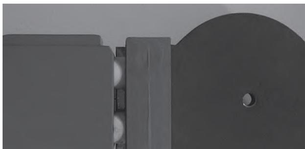
1. Вставить нагревательный элемент между подготовленными трубами.
