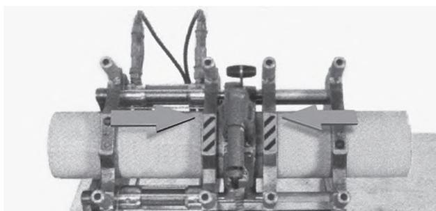
2. Одновременно оба конца трубы подаются к нагревательному элементу под давлением.
