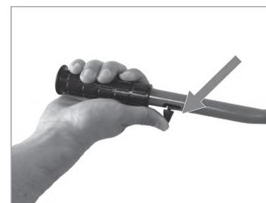
9. Потяните вниз блокиратор чтобы разъединить рычаг и насадку на тиски, поднимите ручку тисков в верхнее положение, тиски автоматически разъединятся;
