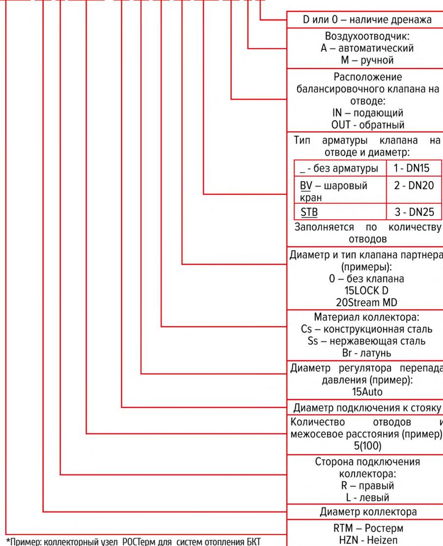
\*Пример: коллекторный узел РОСТерм для систем отопления БКТ RTM-25-L-2(50)-25.20Auto CS-20Stream MD-STB11/IN-A-D
