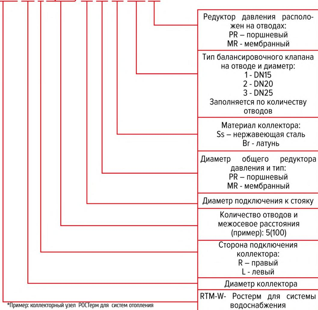
\*Пример: коллекторный узел РОСтерм для систем отопления
