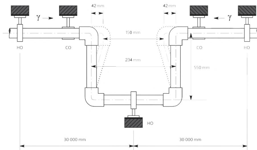
Полученные данные определяют размеры П-образного компенсатора равные: 550 мм x 234 мм.
