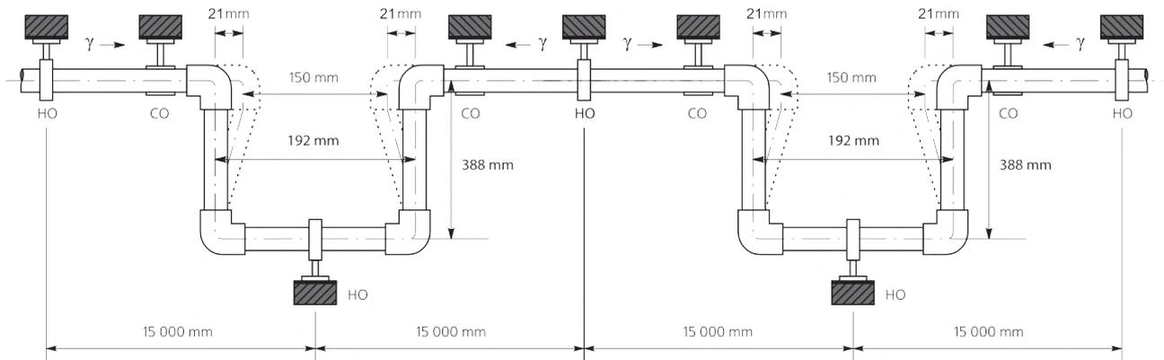
Полученные данные определяют размеры П - образного компенсатора равные: 388 мм x 192 мм.
