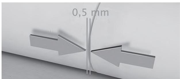
4. Проверить ширину зазора между сведенными трубами (не более 0,5 мм).
