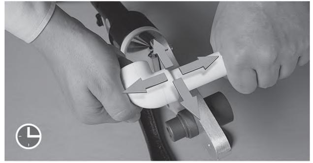
Трубы диаметром 50-125 мм, с целью удобства и упрощения монтажа, рекомендуется сваривать специальным сварочным аппаратом. Такой сварочный аппарат является стационарным инструментом и за счет встроенного фиксирующего механизма элементов позволяет осуществлять предварительный высокоточный монтаж сложных конструкций или элементов системы.
